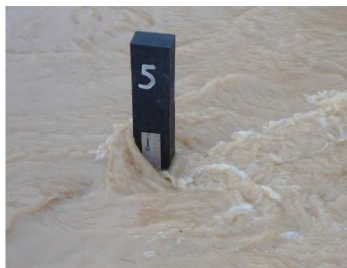
Figura 4-7: Nível d'água na estação fluviométrica na enchente de dezembro de 2013, com 4 metros e 90 cm de altura. (Fonte: Defesa Civil de Afonso Cláudio)
