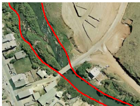
Figura 7-8: Vista aérea das margens do rio Castelo próximo a ponte na Estrada para a Rodovia do Contorno. Em destaque o afunilamento do rio Castelo após essa ponte.
