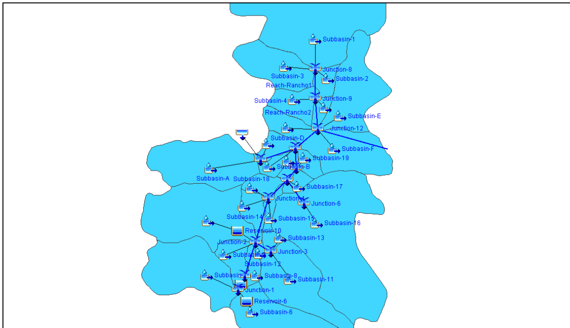
Figura 6-27: Bacia de drenagem urbana do Rio Jucu Braço Sul modelada pelo software HEC-HMS.
