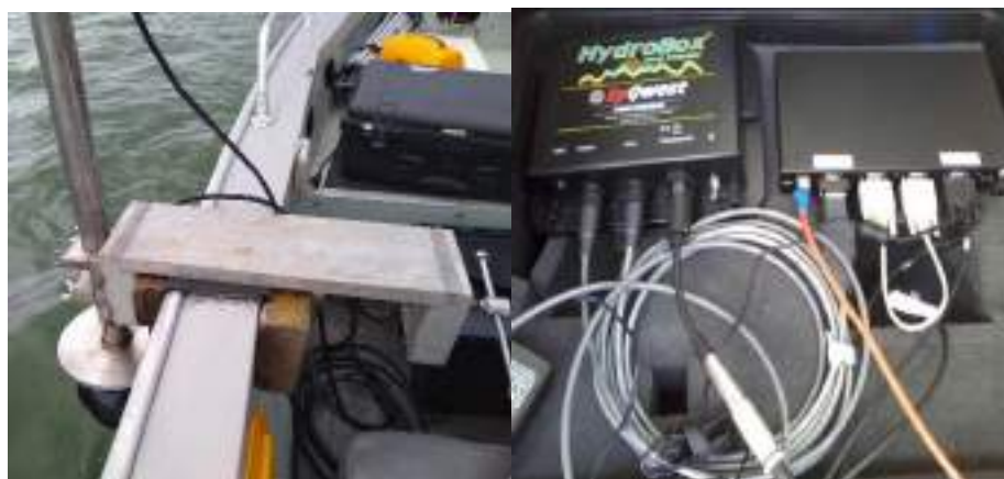
Figura 8 – Exemplo de levantamento feito por Ecobatímetro.
