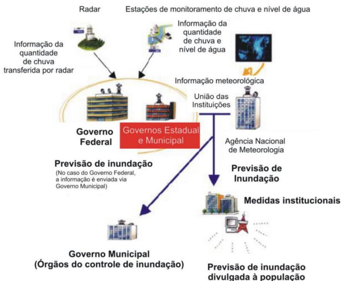
Figura 11-7 - Estrutura esquemática de uma rede de monitoramento e previsão de alerta.
